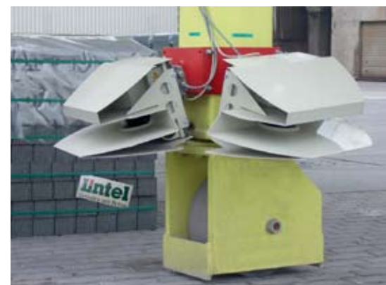
Sikkerhedsscanner OS2000 består udover selve scanneren også af en sikkerheds PLC.
