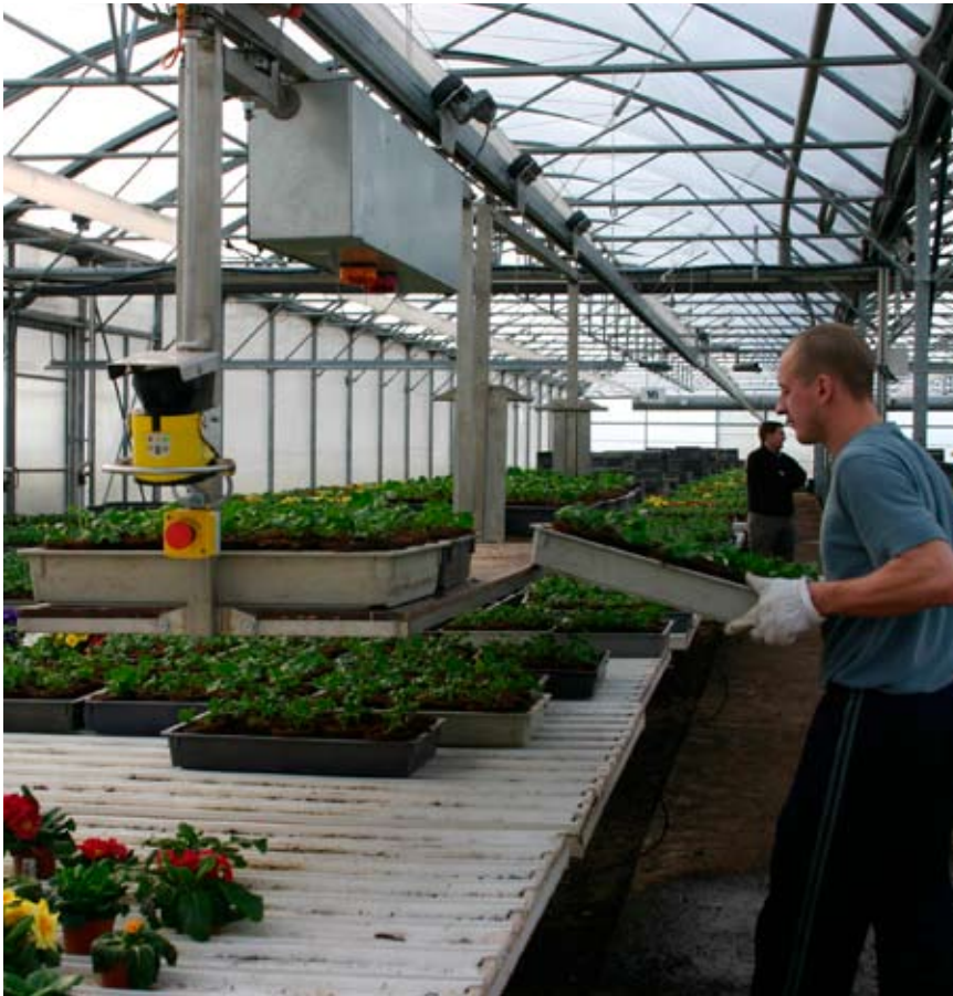
Transportsystemet kører planterne ud i drivhuset. Personalet skal kun løfte bakkerne ned på bordet. Laserscanneren holder øje med, at vognen ikke påkører noget eller nogen.
