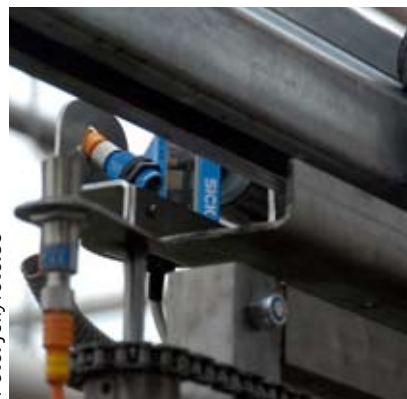
Sensorerne og strekkodelæseren giver styringen besked på, hvad vognen skal fortage sig
