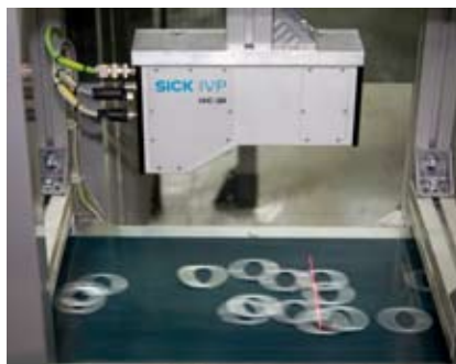
3D-vision kamera måler flangernes form og position
