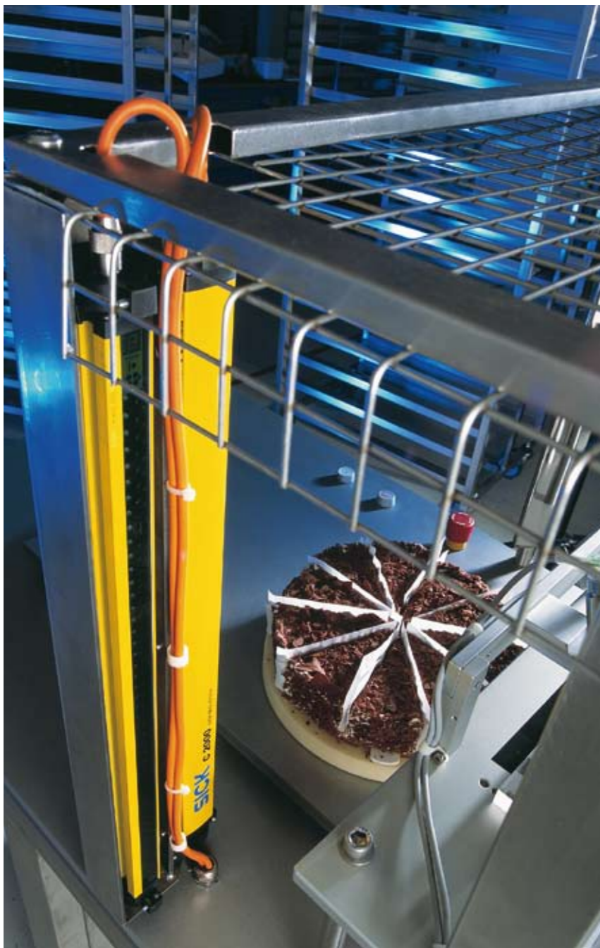
Sikkerhedslysgitteret C2000 kan med fordel benyttes i stedet for mekanisk hegn på mange sikkerhedsapplikationer. Løsningen sikrer operatøren nem adgang til maskinen.
