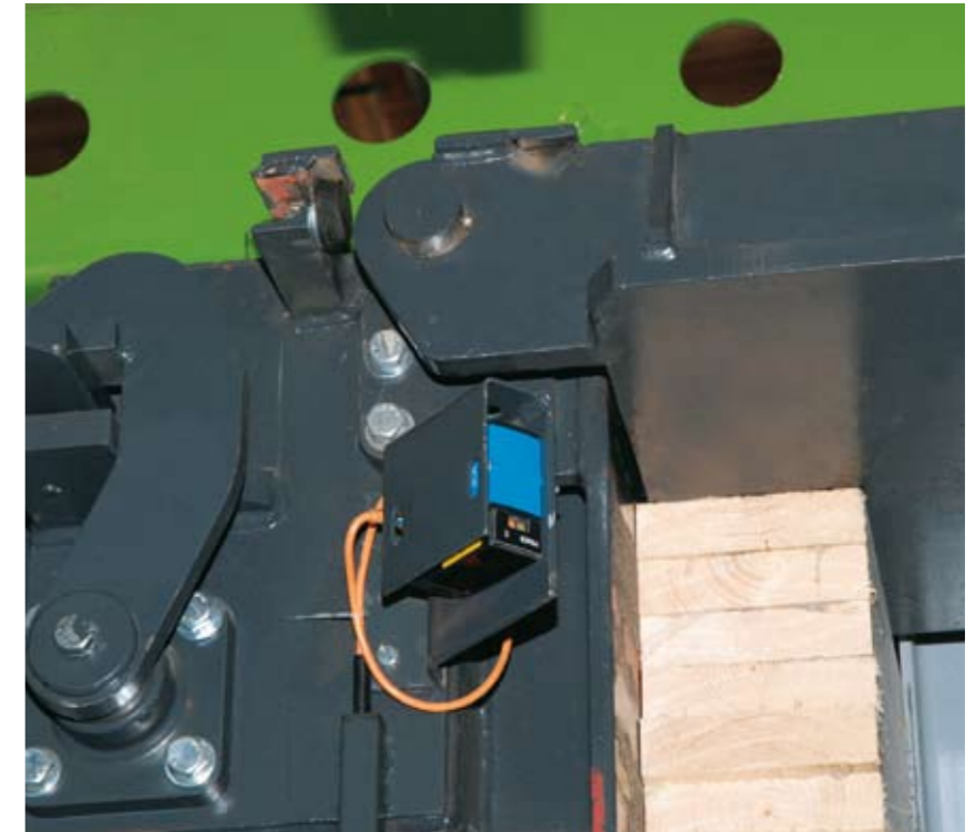
DS60 afstandsmåler positionerer hydraulikcylinderen.
