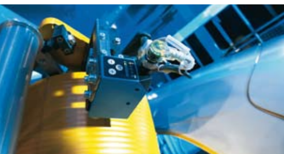
Farvesensoren CS8 direkte integreret i robotens dispenserhoved sikre optimal udnyttelse af taperullerne
