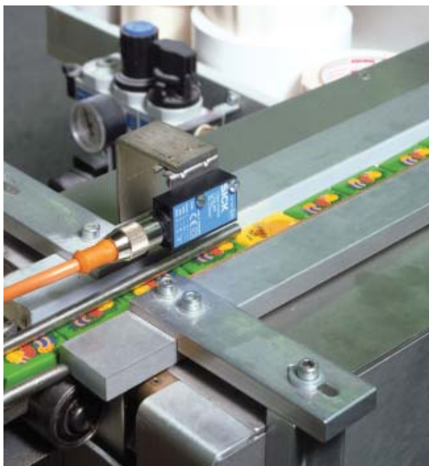
Sortering efter farve med CSM.
