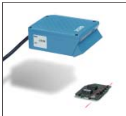
Læsning af 2-D kode på print.
