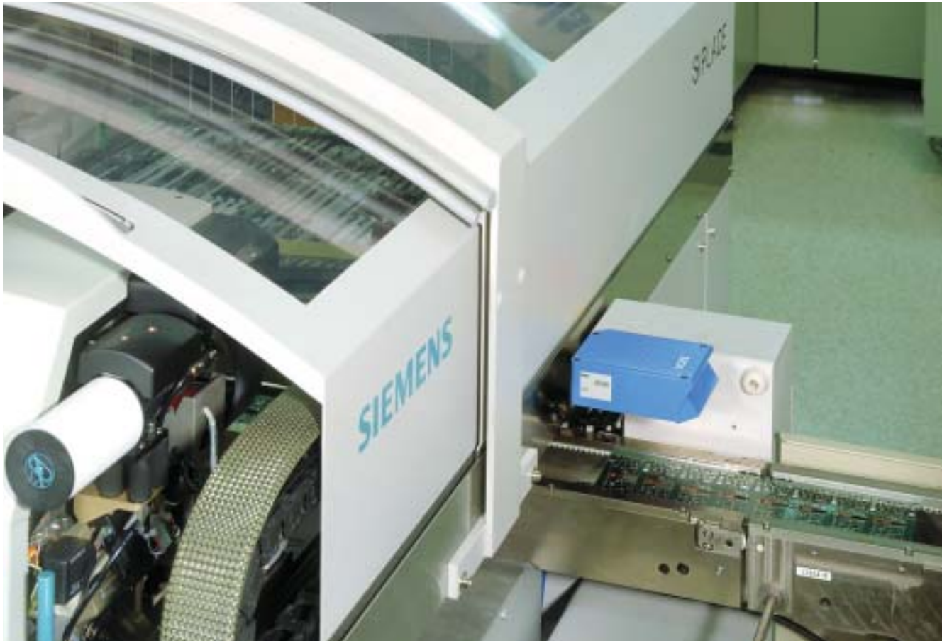
ICR 850 installeret på SMD maskine.
