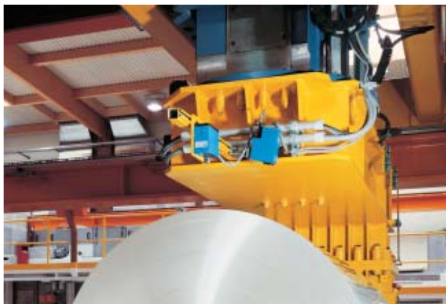
Tykkelsesmåling af coil med DT 200.
