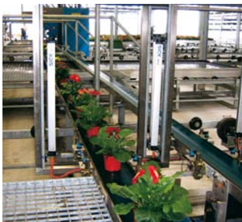
MLG lysgitter registrerer højden på de færdige planter
