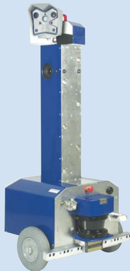
Den selvkørende sikkerhedsrobot MG 400 – navigationen er styret af et LMS baseret målesystem.
