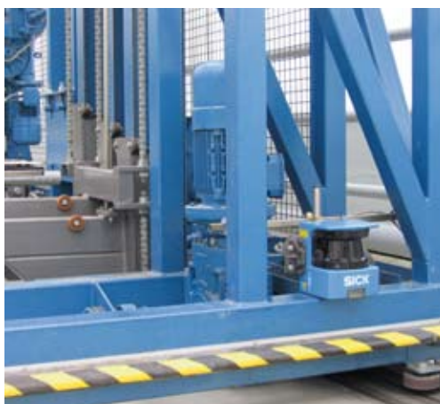
Transport foregår automatisk med LMS navigation
